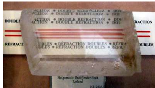
Dubbelbreking door een calcietkristal
